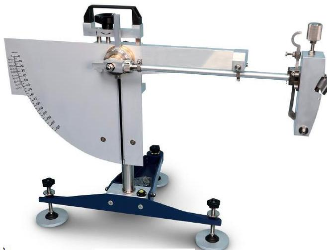
Il pendolo misura la perdita di energia quando il pattino in gomma scorre lungo la superficie durante una prova. Il meccanismo di rilascio del pendolo è di estrema accuratezza in quanto si riduce al minimo l'attrito.
